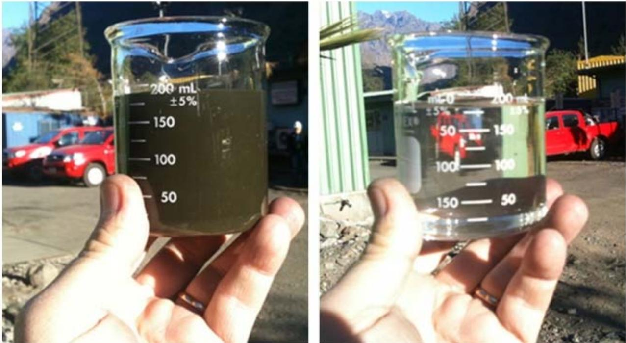
**El Clarificador de Aguas y Espesamiento de Sólidos por Procesos de Succión, CEPS, logra limpiar en altos niveles aguas industriales y riles, tanto para sus procesos de tratamiento como para la recuperación de sólidos ultra finos de alto valor, por ejemplo, concentrados en la minería. Esta tecnología desarrollada en Chile por EQIIP, es aplicada industrialmente con éxito en Minera Los Pelambres, Molymet S.A. y Codelco, entre otras, además de la empresa KFA de Corea del Sur, en Asia.**
