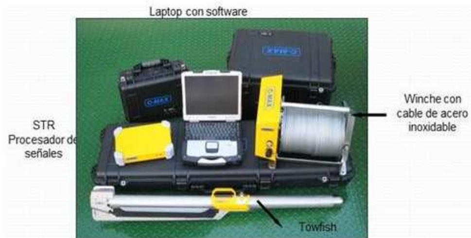
Figura 6.- Equipamiento completo de sonar de barrido lateral C-Max.
