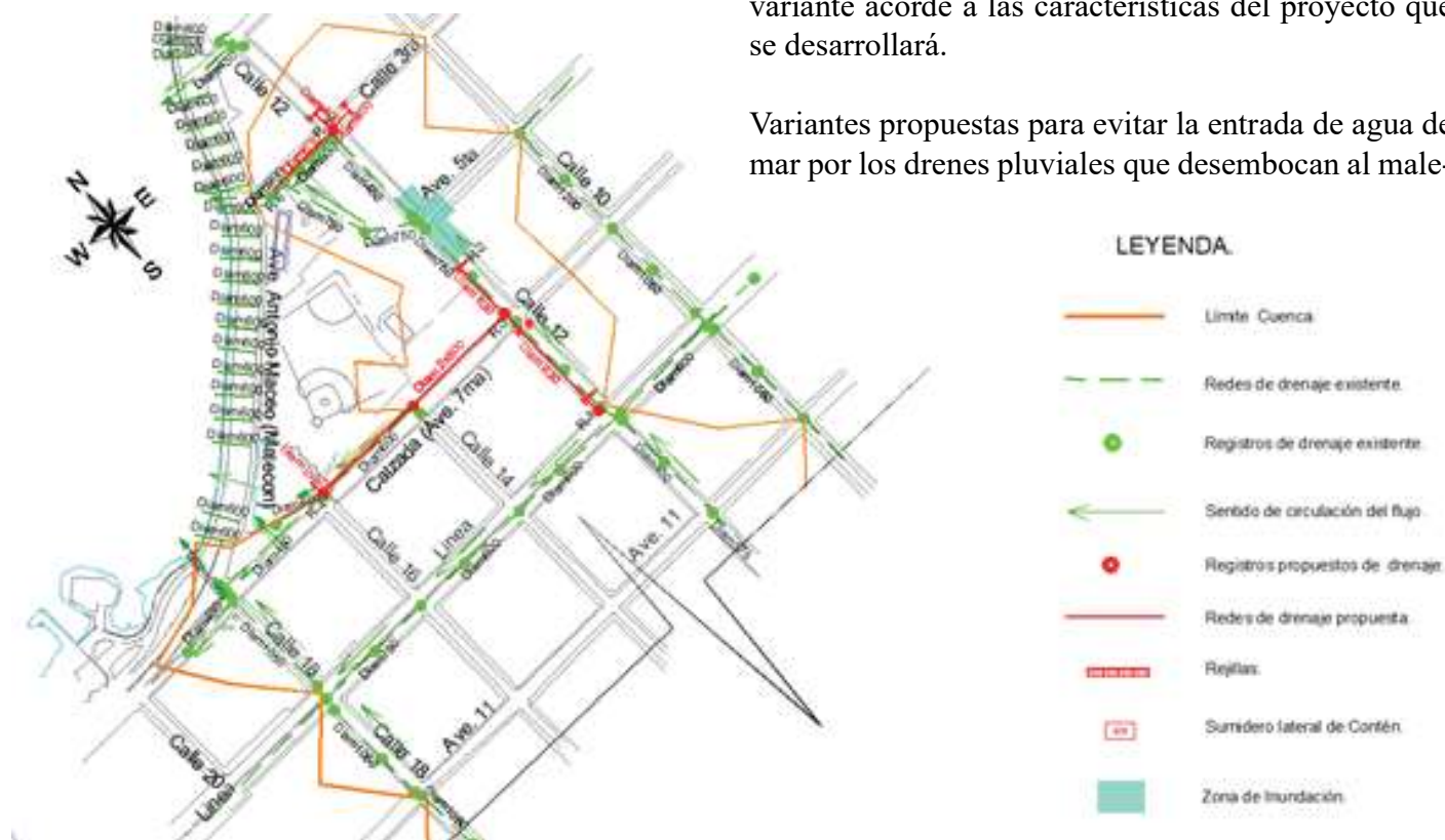
Figura 4.- Solución de las redes de drenaje en la zona del “Club 500”. (Plano confeccionado por el autor).
