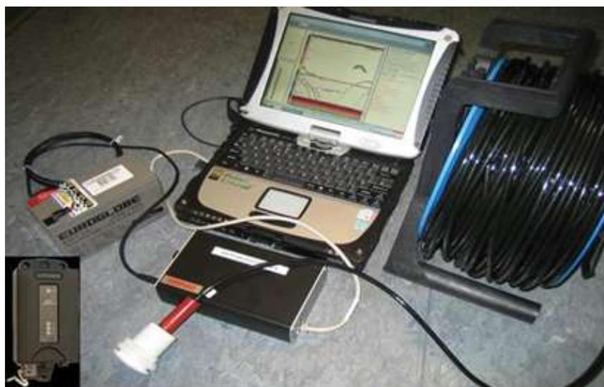
Figura 2.- Ecosonda científica EK15 con transductor de haz simple de 200 kHz.
